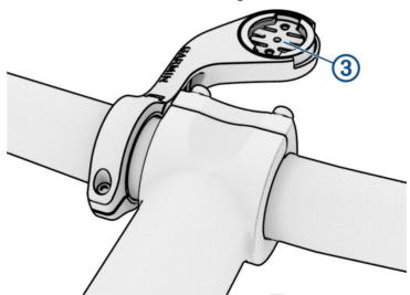
7 Appuyez légèrement sur l'ordinateur de vélo Edge et faites-le pivoter dans le sens des aiguilles d'une montre jusqu'à ce qu'il soit bien en place.
